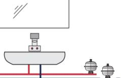
воду к приборам с малым временем перекрытия потока: рычажные водоразборные краны и смесители, шаровые краны, душевые переключатели, электромагнитные клапаны ( в том числе клапаны стиральных, посудомоечных машин и гидромассажных устройств) и т.п.
