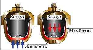
При резком закрытии крана затухание избыточного давления происходит через воздушную камеру и мембрану из EPDM, которые, противодействуют силе жидкости. Поступающая жидкость выдавливает мембрану в сторону воздушной камеры, воздух сжимается, поглощая избыточное давление. После того как давление стабилизируется - воздушная камера выдавливает воду обратно в трубопровод.
